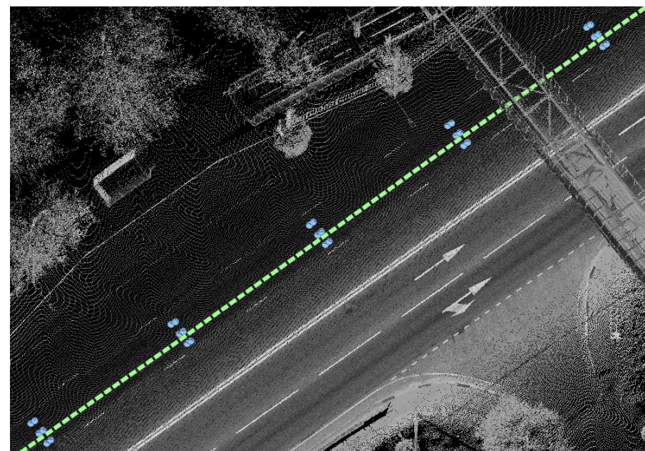
Траектория движения и точки георадиолокационного сканирования на облаке точек лазерного сканирования
