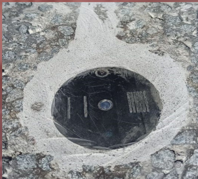
Встроенный датчик состояния дорожного покрытия ДП.10 «Круг»
