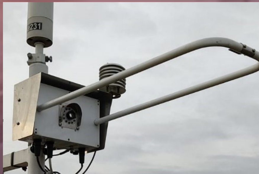
Датчик атмосферных осадков ДО.10 «Луч»
